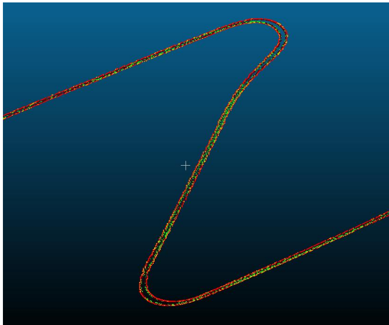
Visualisation du modèle 3D du trajet parcouru avec 4 GNSS sur le toit de la Kangoo
